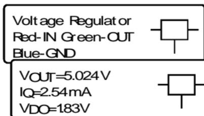
Quando um regulador é identificado, a pinagem, voltagem de saída, consumo de corrente quando em repouso e queda de tensão são apresentadas.
