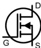
MOSFET significa *Metal Oxide Semiconductor Field Effect Transistor* (Transístor Semicondutor de Efeito de Campo de Óxido Metálico). Como os transístores bipolares, os MOSFETS estão disponíveis no Canal-N e Canal-P. A maior parte dos MOSFET modernos são do tipo Modo de Aumento, o que significa que a tendência da tensão é sempre positiva (para os tipos do Canal-N). O outro tipo de MOSFET é do Modo de Perda, descrito numa secção mais abaixo.
