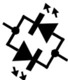
Esta secção descreve o teste de LEDs bicolores de 2 terminais. Estes tipos estão internamente conectados em inverso paralelo (*back-to-back*).
