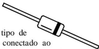
O *DCA Pro* irá analisar praticamente qualquer tipo de díodos. Qualquer par das 3 ponteiros pode ser conectado ao díodo. Se o aparelho detetar um único díodo, uma mensagem semelhante à de baixo será apresentada:
