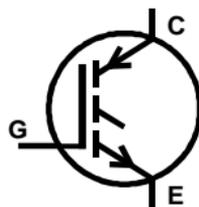
Combina as características de entrada de um MOSFET com as características de saída de um Transfistor de junção Bipolar.
