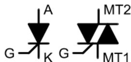
Os tirístores sensíveis de baixa potência (*Silicon Controlled Rectifiers* - SCRs) e os triacs que necessitam de correntes de *gate* e correntes de menos de 10mA podem ser identificadas e analisadas com o **DCA Pro**.
