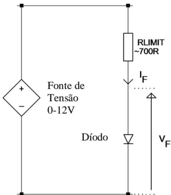
Este circuito de teste é usado para testar as características dos díodos. As características invertidas são particularmente úteis para testar os díodos *Zener*.
