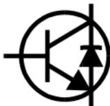
Para os transístores NPN, o ânodo do díodo está conectado ao emissor do transístor. Para transístores PNP, o ânodo do díodo está conectado ao coletor do transístor.
