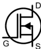
Os raros MOSFET de Modo de Esgotamento são bastante semelhantes às convencionais junções de FET (JFET) exceto que o terminal *gate* está isolado dos outros dois terminais. A resistência de entrada destes dispositivos pode ser superior a 1000M $\Omega$  para tensões de *gate* positivas e negativas.
