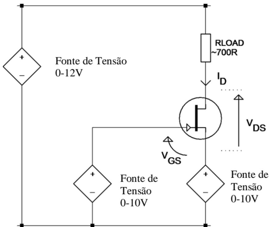
É importante notar que a tensão *gate-source* pode ser conduzida negativamente ao tornar a condução de tensão fonte do *gate* mais alto do que o condutor de tensão. No entanto, quando isto for feito, existe menos tensão disponível para atravessar os nós *drain-source* e a resistência carregada.
