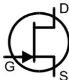
A tensão aplicada através dos terminais *gate-source* controla a corrente entre os terminais *drain* e *source*. Os JFETs de Canal-N requerem uma tensão negativa no seu *gate* respeitando a *source*, quanto mais negativa a tensão, menos corrente poderá fluir entre o *drain* e a *source*.
