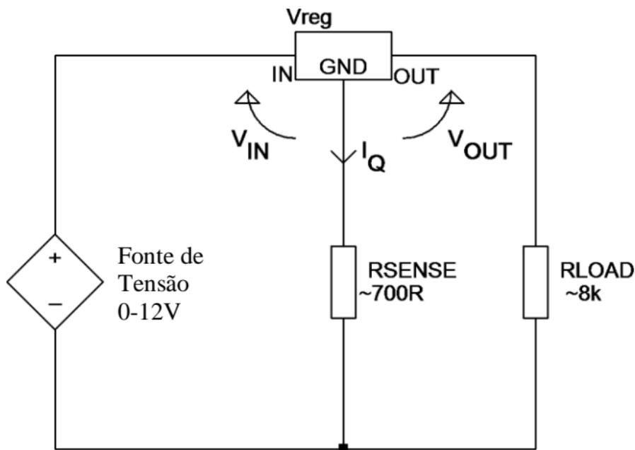
O circuito de teste aqui mostrado é usado para a análise de reguladores de tensão (neste caso, positivos). Note que o raio de tensões suportadas irá depender na corrente em repouso ( $I_Q$ ). Uma corrente em repouso superior irá fazer com que mais tensão “caia” através da resistência sensor e produza menos tensão para o próprio regulador.
