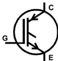
Os IGBTs de Esgotamento são caracterizados pelo facto de a corrente poder fluir entre o coletor e o emissor quando não houver tensão entre os terminais *gate* e emissor.
