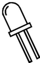
Para peças de dois terminais, conecte quaisquer garras no LED, deixando a terceira ponteira desconectada.
