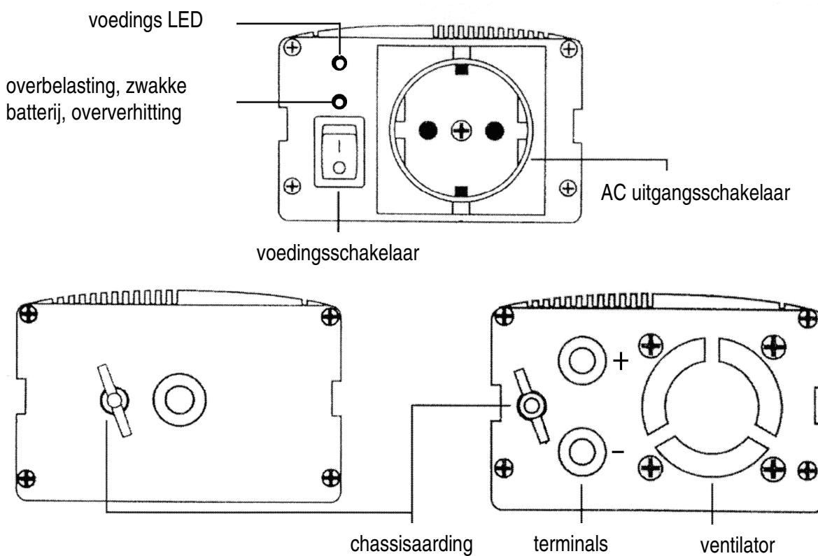
**Verleng de meegeleverde kabel niet! Dit kan tot te veel spanningsverlies leiden of de kabel oververhitten.**
